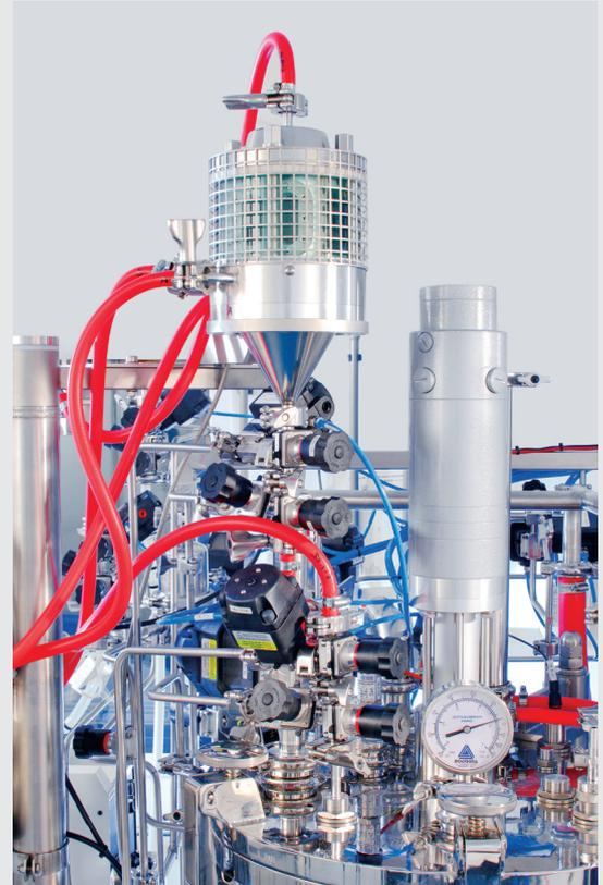
**Le BioSep 200 I est un système de rétention pour perfusions, concentration et nettoyage de cultures cellulaires** sur cuve stérilisable en place de 200 l et plus. Le système utilise les ultrasons pour séparer les cellules du milieu permettant d'atteindre de fortes concentrations cellulaires sur des durées de cultures allongées (plusieurs mois).
