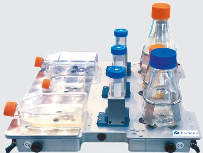
**Le module SFR Shake Flask Reader permet la mesure simultanée et en ligne de la pO<sub>2</sub>, du pH (ou CO<sub>2</sub>) sur les fioles erlenmeyer.** La mesure du pH (CO<sub>2</sub>) et de l'oxygène est basée sur un principe optique de fluorescence intégré dans des erlens prêts à l'emploi où via une intégration manuelle suivant les applications.
