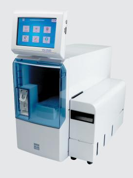
Technique enzymatique fonctionnant via des enzymes immobilisées sur une membrane et plaquées sur une électrode. Cet analyseur est une alternative économique à la version plus complète YSI 2900D pour réaliser des analyses de glucose et lactate uniquement. Il permet un fonctionnement automatisé (plaque de 96 puits) ou manuel (tube à essais en face avant) ce qui en fera un compagnon idéal pour vos analyses.
