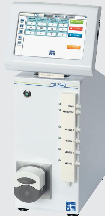
Conçu comme add-on pour de multiples bioréacteurs travaillant en parallèle, ce système automatisé d'échantillonnage 8 voies propose un moyen simple et fiable pour le suivi et le contrôle des analyses biochimiques. Il est compatible avec toute échelle de process, y compris les bioréacteurs à usage unique.
