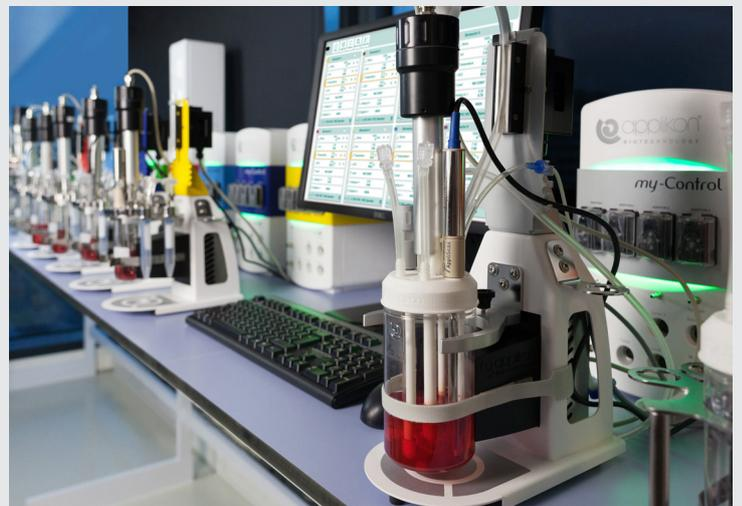
**En plus d'être compatible avec les cuves** le contrôleur my-Control est compatible avec les différentes cuves à usage unique disponibles sur le marché lui conférant une très grande flexibilité.
