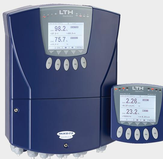
**Couvrant une large gamme de mesures de conductivité, de l'eau (200  $\mu\text{S}/\text{cm}$ ) jusqu'à des concentrations élevées (1000  $\text{mS}/\text{cm}$ ), il est possible d'afficher la mesure en conductivité et / ou en % de concentration.**
