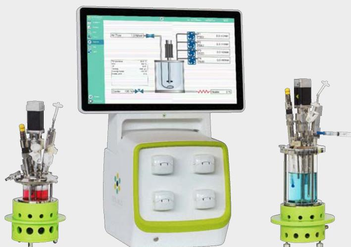
La gamme IO est constituée de systèmes de cultures à petite échelle dont la thermorégulation s'effectue par effet Peltier (l'utilisation d'eau n'est pas nécessaire).
