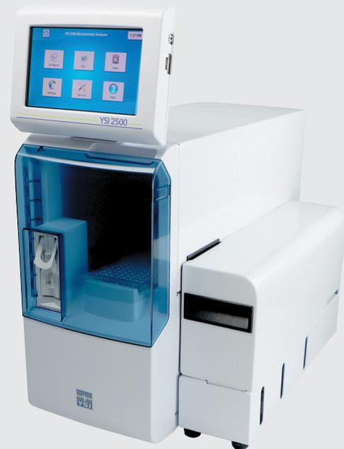
**Technique enzymatique fonctionnant via des enzymes immobilisées sur une membrane et plaquées sur une électrode.** Cet analyseur est une alternative économique à la version plus complète YSI 2900D pour réaliser des analyses de glucose et lactate uniquement. Il permet un fonctionnement automatisé (plaque de 96 puits) ou manuel (tube à essais en face avant) ce qui en fera un compagnon idéal pour vos analyses.
