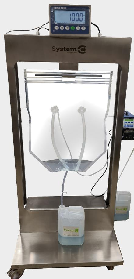
Station de pesée pour poches suspendues compatible avec l'ensemble des pompes intelligentes PARKER.
